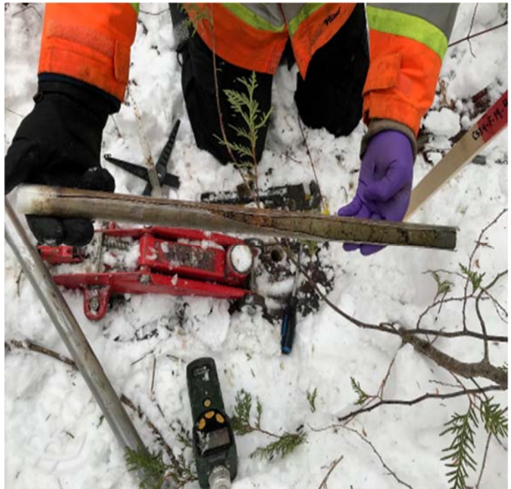
Géoprobe manuelle, Golder 2019
