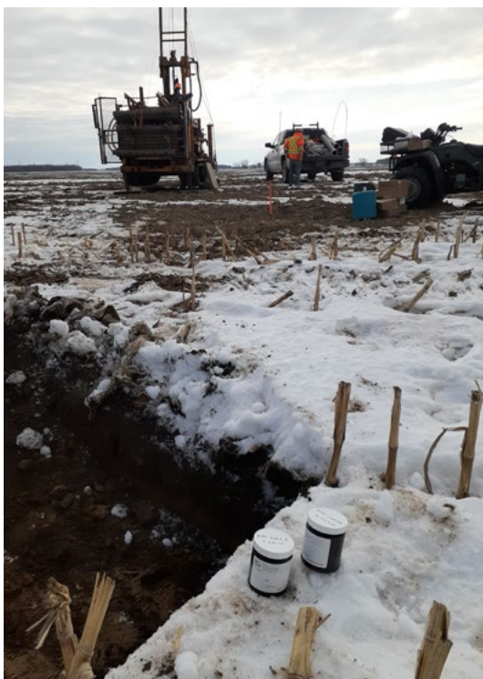
Caractérisation environnementale des sols réalisée par une firme privée en mars 2023 sur un site de puits inactif d'hydrocarbures.
