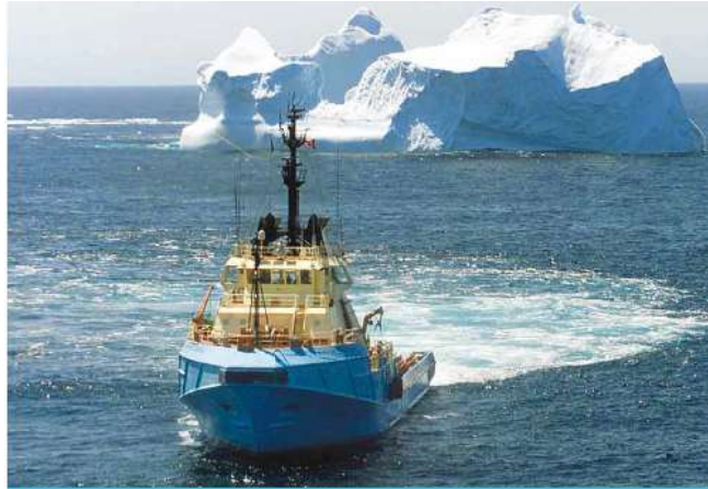
FIGURE 5-3. REMORQUEUR-MANIPULATEUR D'ANCRE MAERSK DE TYPE HUSKY (MAERSK, 2015)
