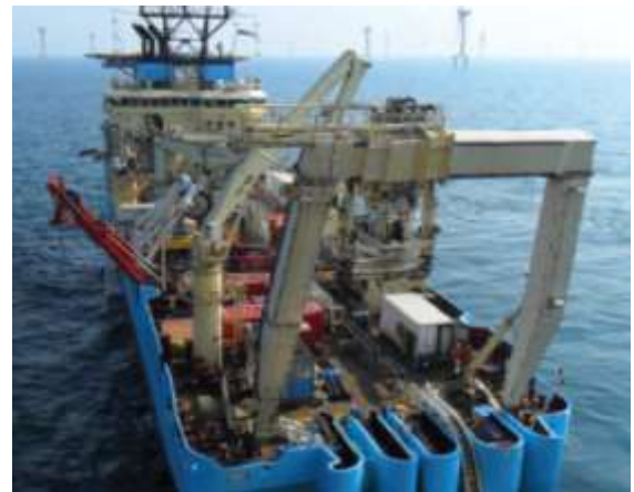
PORTIQUE ET GRUES À FLÈCHE DU MAERSK RECORDER (DEEPOCEAN, 2015)
