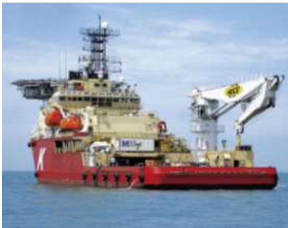
GRUE À FLÈCHE ARTICULÉE HEILA À COMPENSATEUR DE PILONNEMENT ACTIF (HEILA, 2015)
