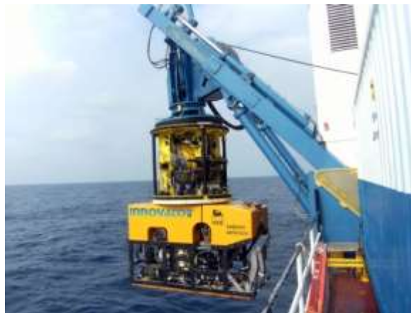
FIGURE 5-4. SLR HAWBOLDT METTANT À L'EAU UN VÉHICULE TÉLÉGUIDÉ (RS AQUA, 2015)
