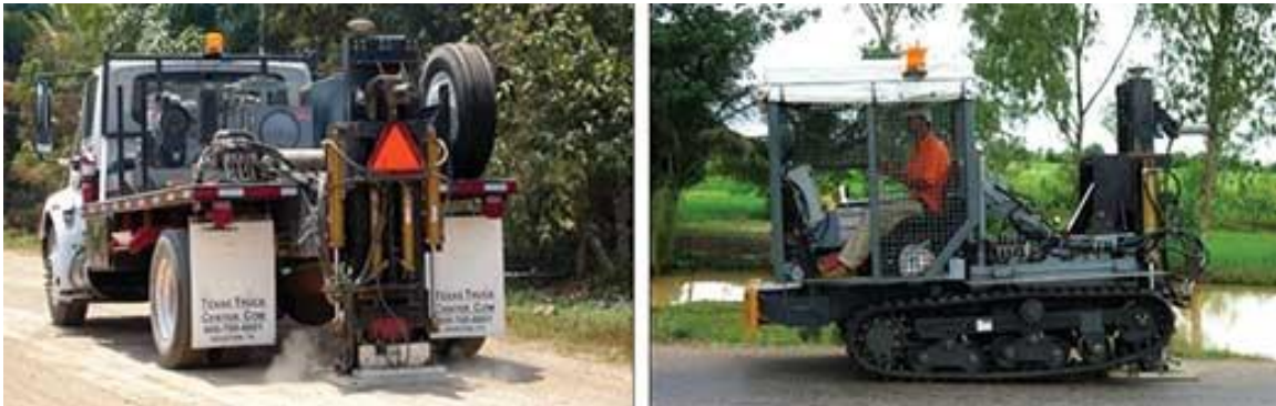
Figure 11: Deux différents modèles de masse accélérée sur des véhicules adaptés. [Image tiré de http://www.pgs.com/Geophysical-Services/Technical_Library/TechLink_Articles/TechLink-April-2009/Minimal-Impact-Seismic-Acquisition-Successful-Imaging-using-an-Accelerated-Weight-Drop-System/ ]
