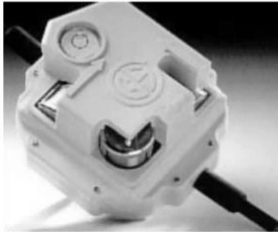
Figure 9: Géophone 3C pour l'acquisition terrestre [Tiré de (Keary et al., 2002)].
