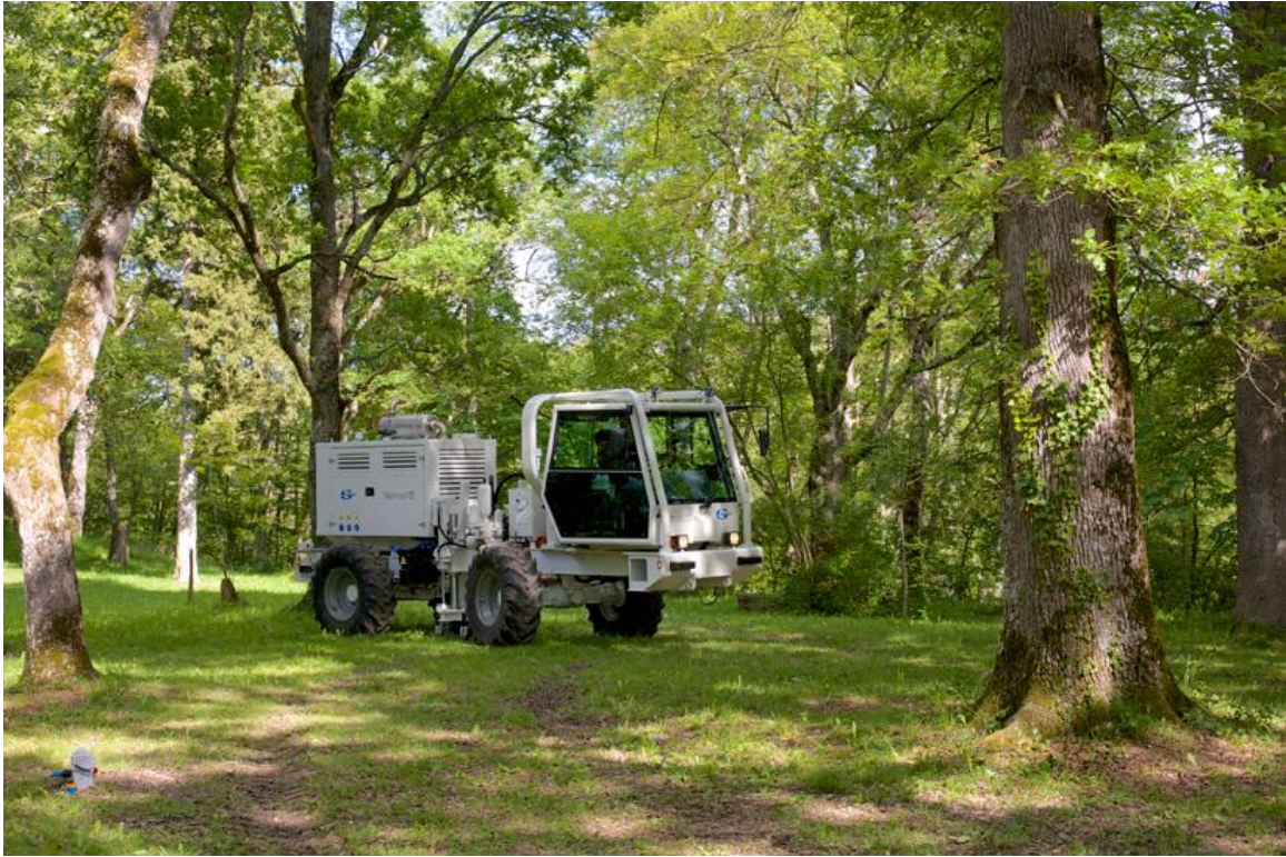
Figure 13: Exemple d'un petit camion vibreur de 15000 lbs. [Image tirée de http://www.sercel.com/products/Pages/Nomad_15.aspx ]
