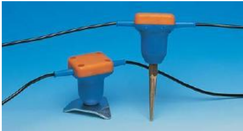
Figure 8: Géophones montés sur une plaque et sur un piquet. Les plaques sont utilisées quand le sol est trop dur pour enfoncer le piquet ou quand les sédiments de surface sont des sables secs et que le couplage est insuffisant. [Image tirée de http://www.azosensors.com/equipment-details.aspx?EquipID=255 ]
