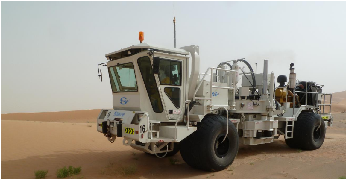
Figure 14: Exemple d'un des plus gros camions vibreur de 90000lbs. [Image tirée de http://www.sercel.com/news/Pages/Nomad-90-Neo.aspx ]
