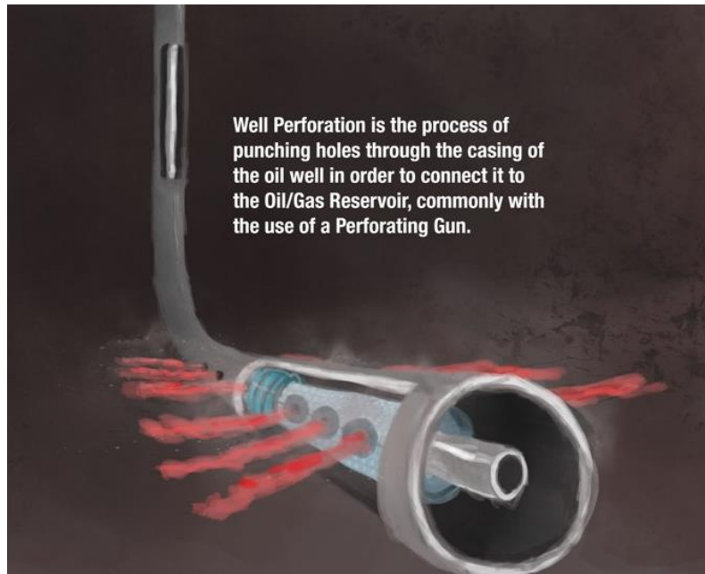
Figure 15 - Illustration d'une perforation dans un puits horizontal (DrillingInfo, 2014).
