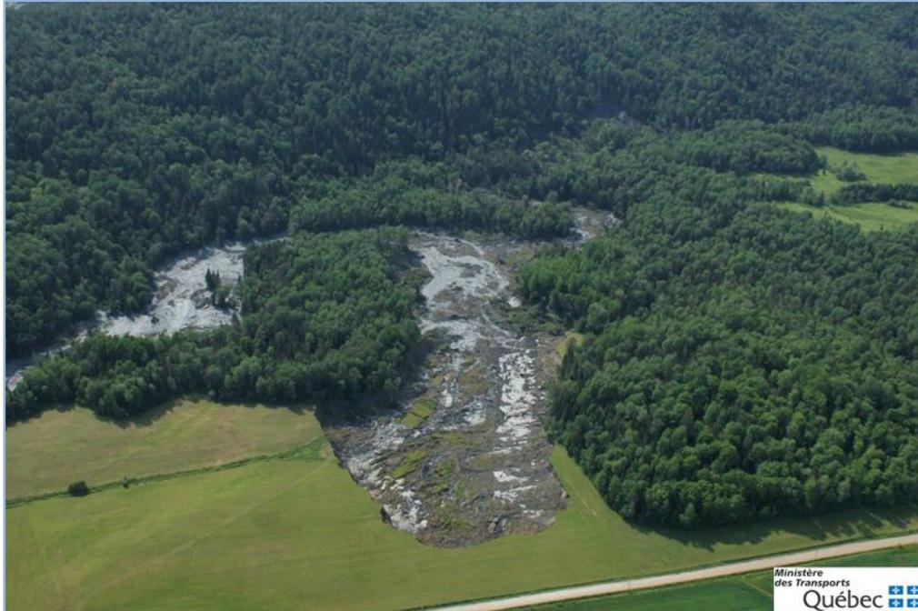
**Figure 2 : Glissement de terrain dans des argiles sensibles survenu en juin 2010 à Notre-Dame-de-la-Salette. La distance de recul est de 425 mètres et la largeur de 150 mètres.**
